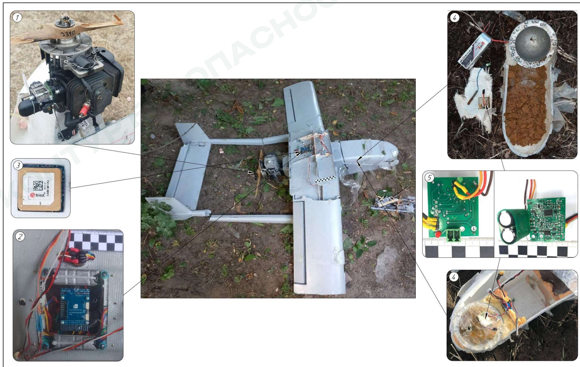
Рис. 14. Внешний вид и элементы конструкции БВС «Чайка»
