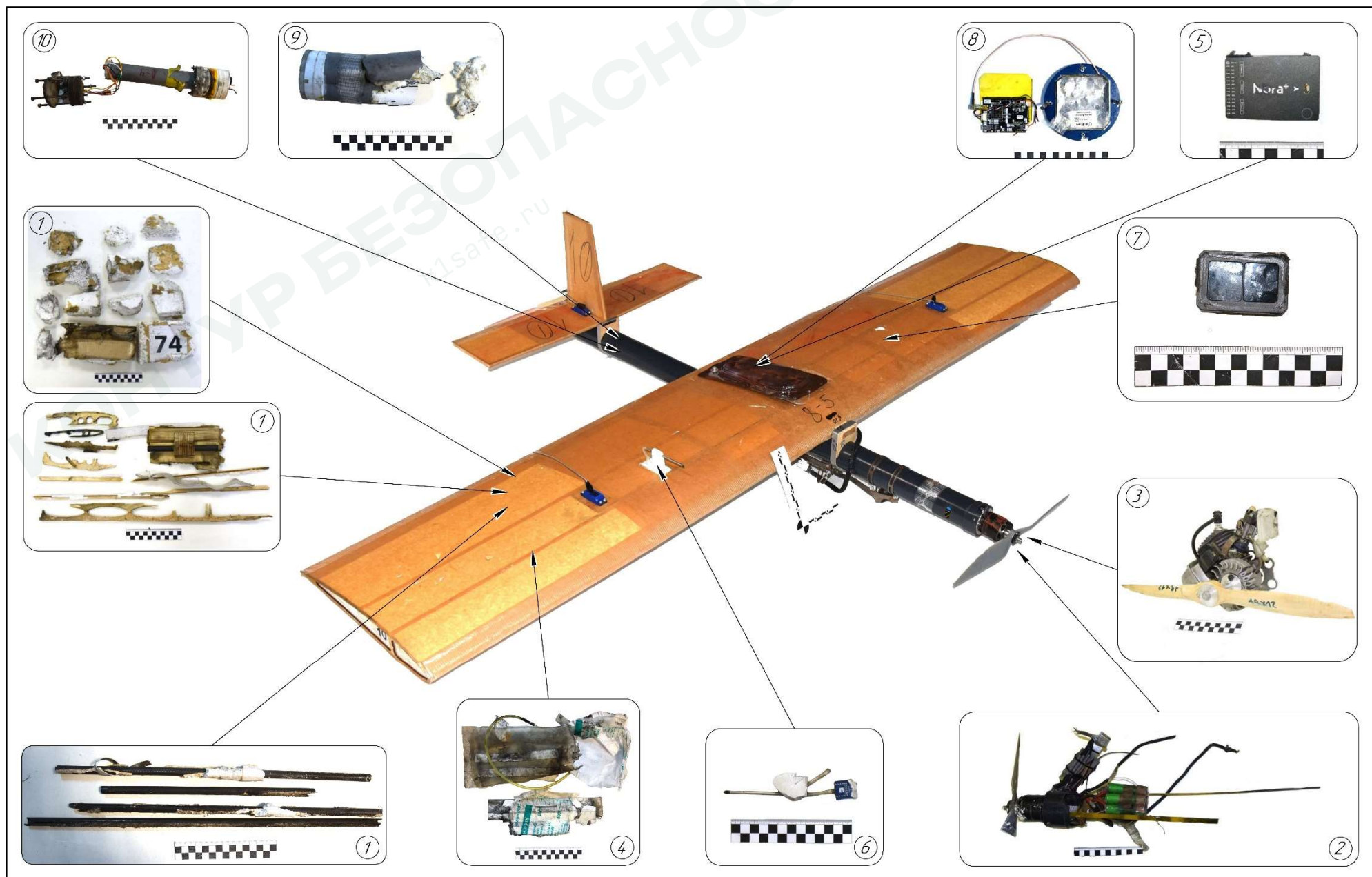
Рис. 4. Внешний вид и элементы конструкции БВС «Спис»
