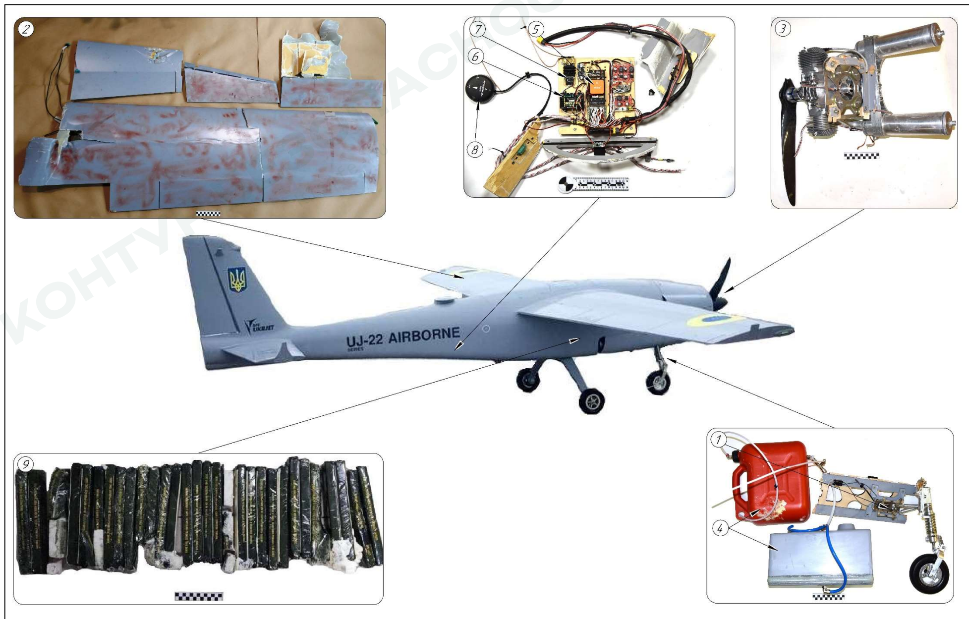
Рис. 20. Внешний вид и элементы конструкции БВС UJ-22 «Airborne»
