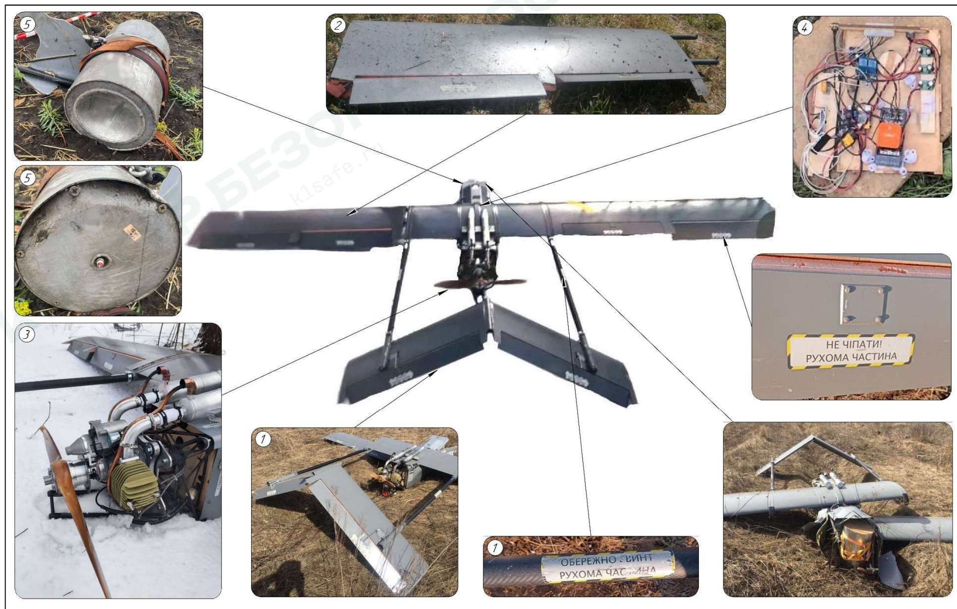
Рис. 32. Внешний вид и элементы конструкции БВС «FP-1»
