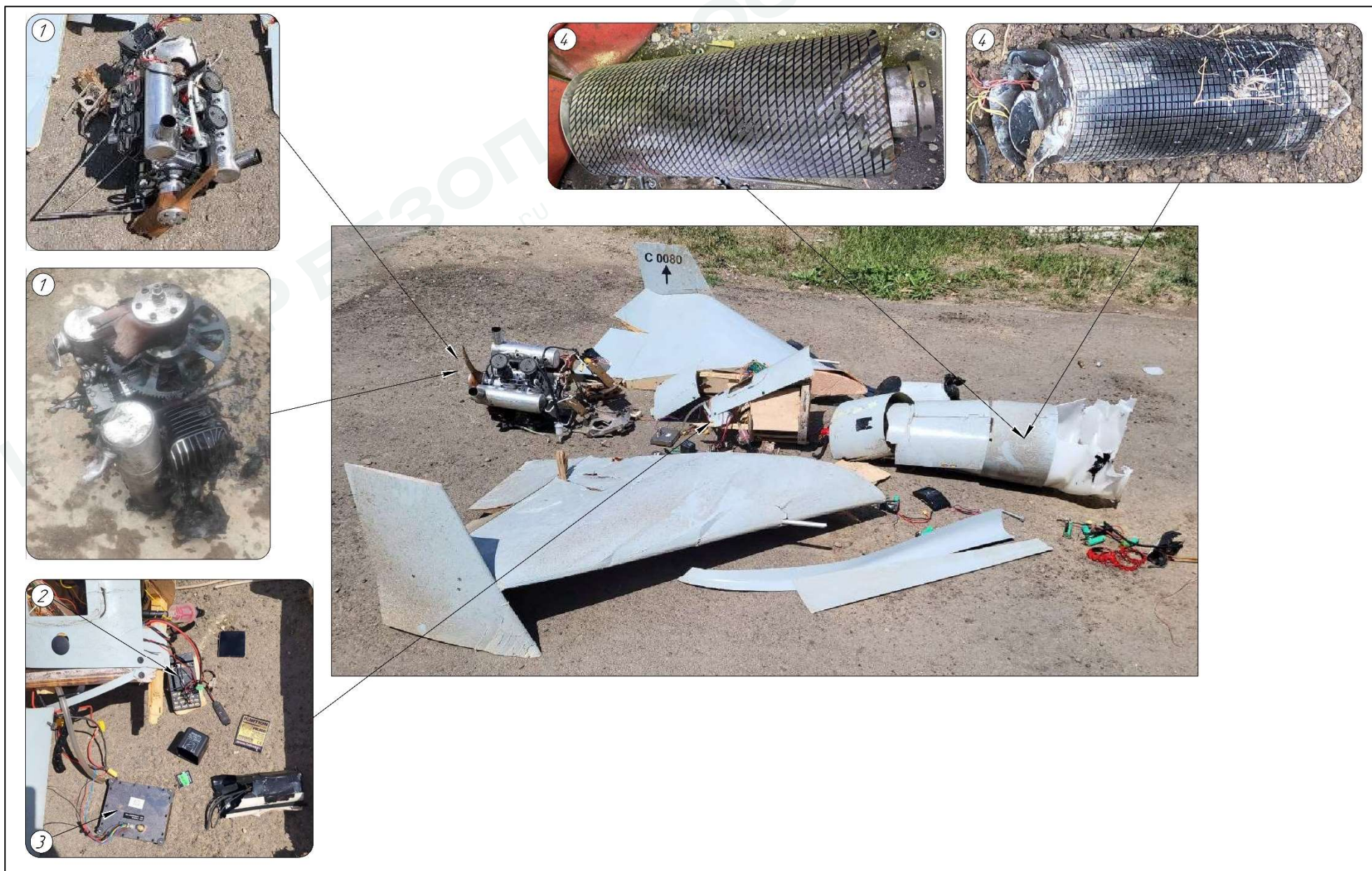
Рис. 30. Внешний вид и элементы конструкции БВС «Журавец»
