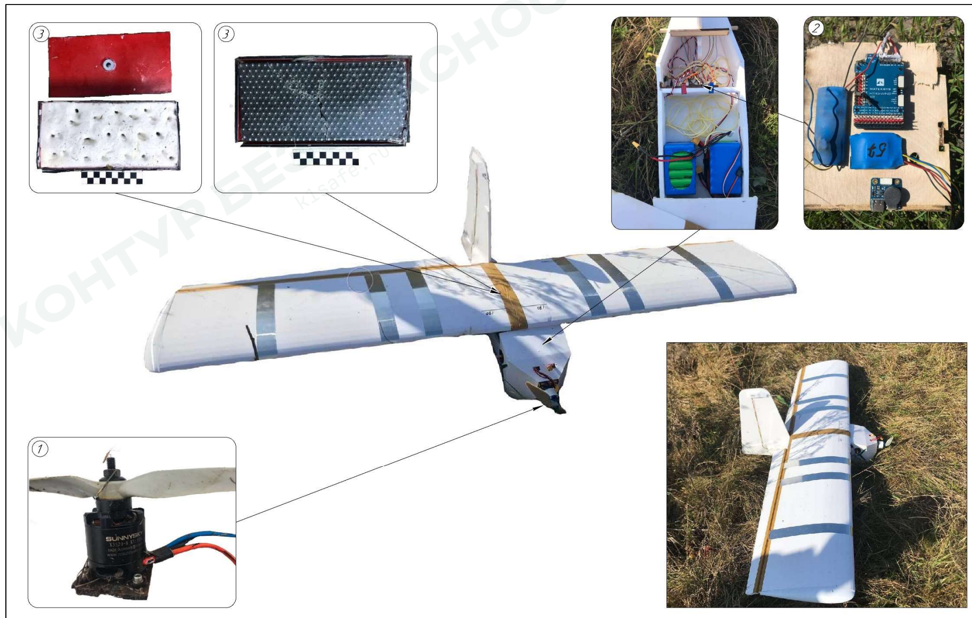
Рис. 3. Внешний вид и элементы конструкции БВС «Sticker»
