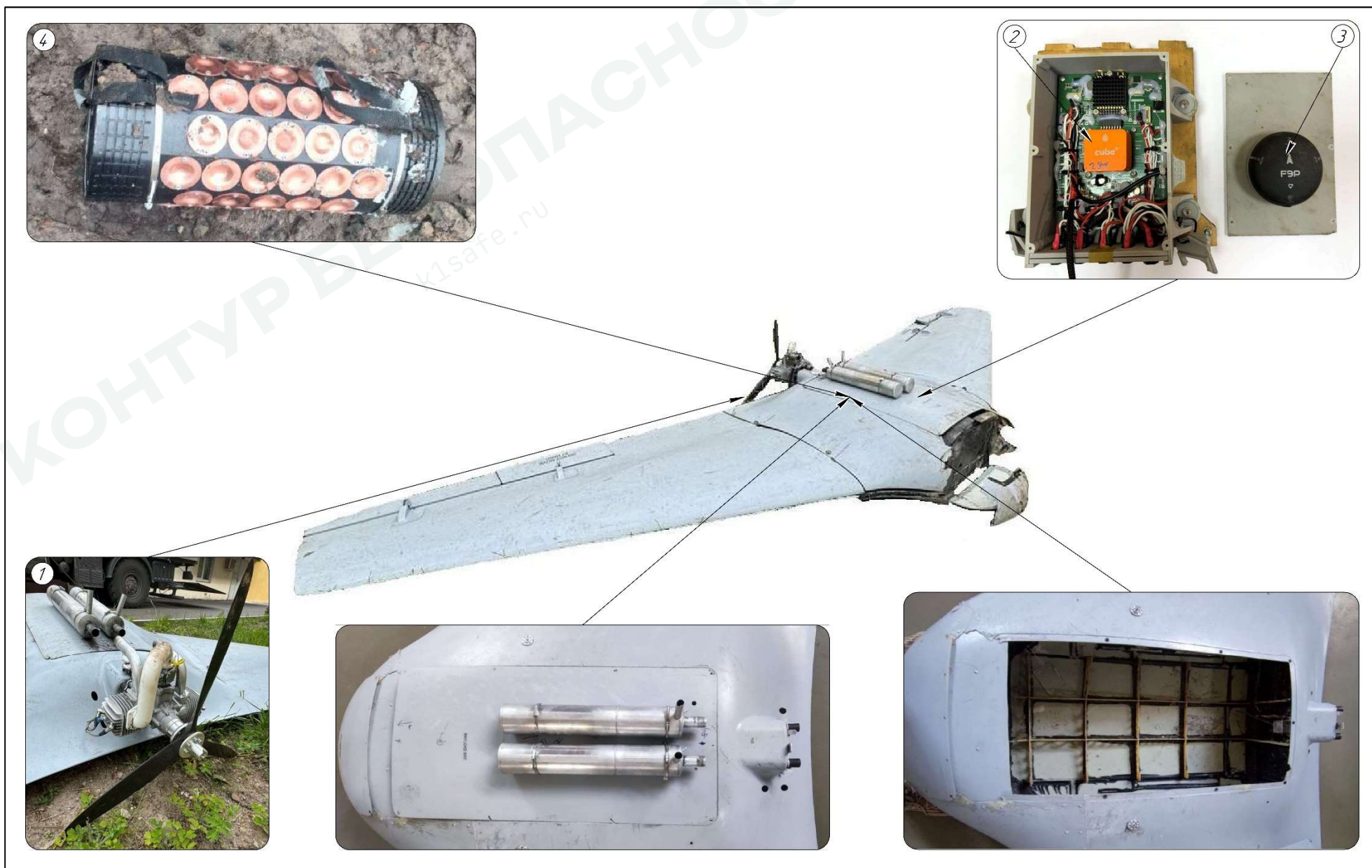
Рис. 29. Внешний вид и элементы конструкции БВС «Катран»
