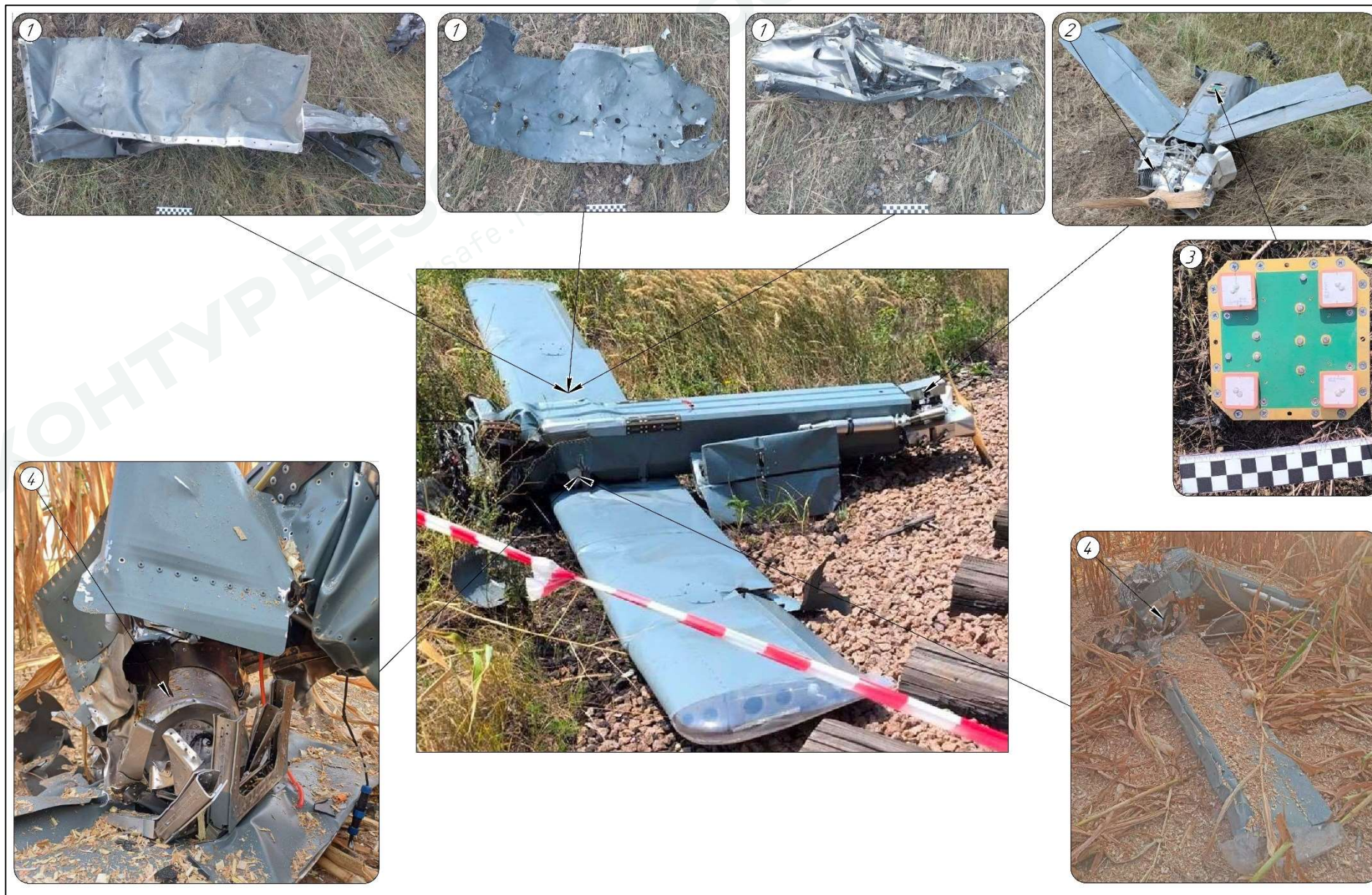
Рис. 24. Внешний вид и элементы конструкции БВС «Дюраль»
