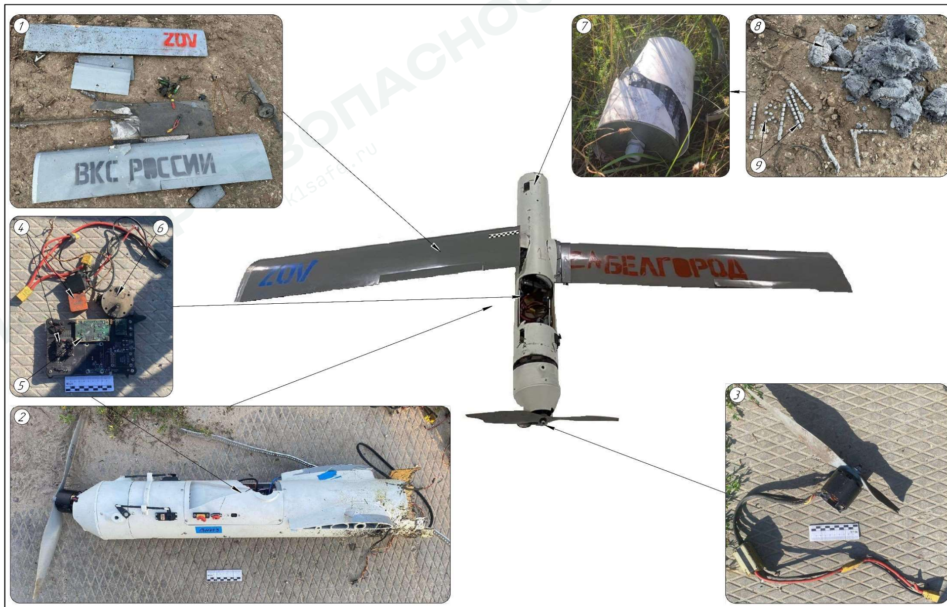
Рис. 15. Внешний вид и элементы конструкции БВС «Микола-1»
