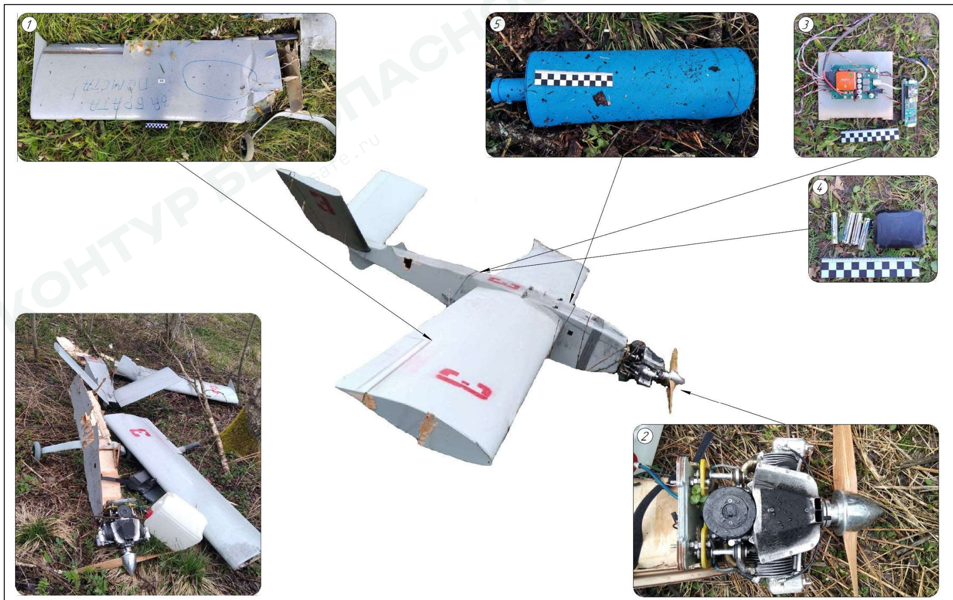
Рис. 23. Внешний вид и элементы конструкции БВС «Орел»
