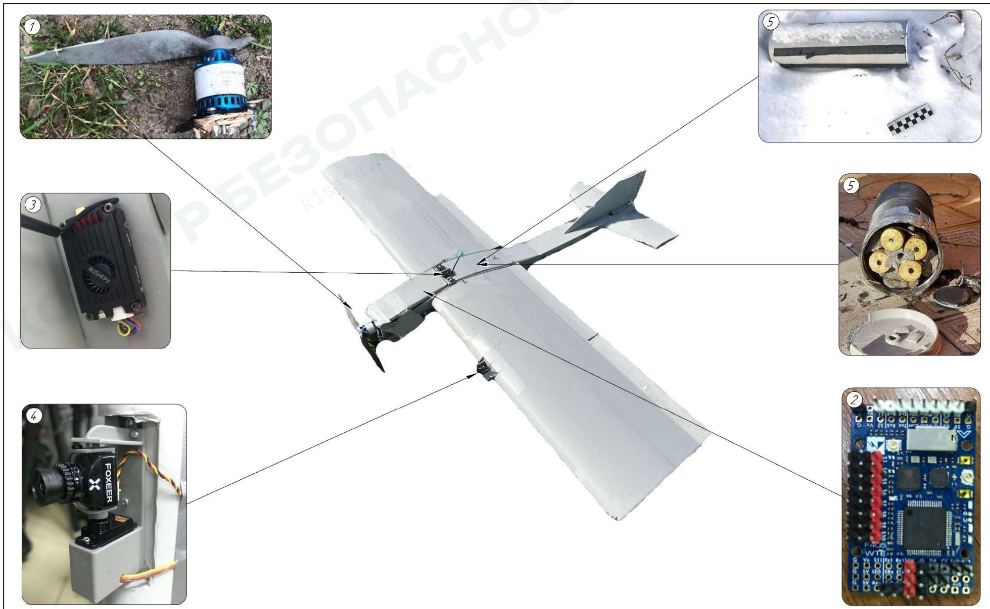
Рис. 5. Внешний вид и элементы конструкции БВС «Darts»
