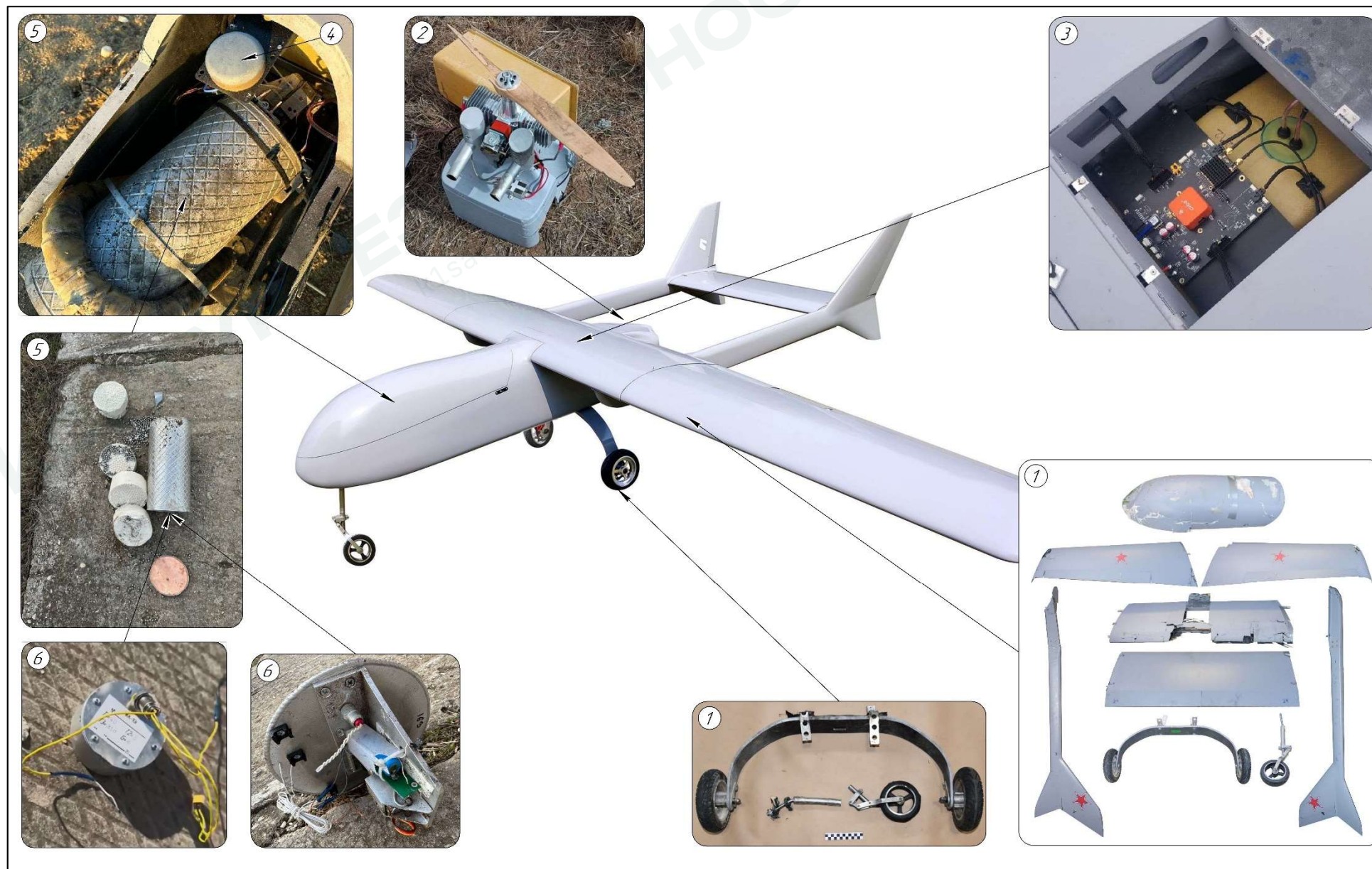
Рис. 19. Внешний вид и элементы конструкции БВС «Mugin-5»
