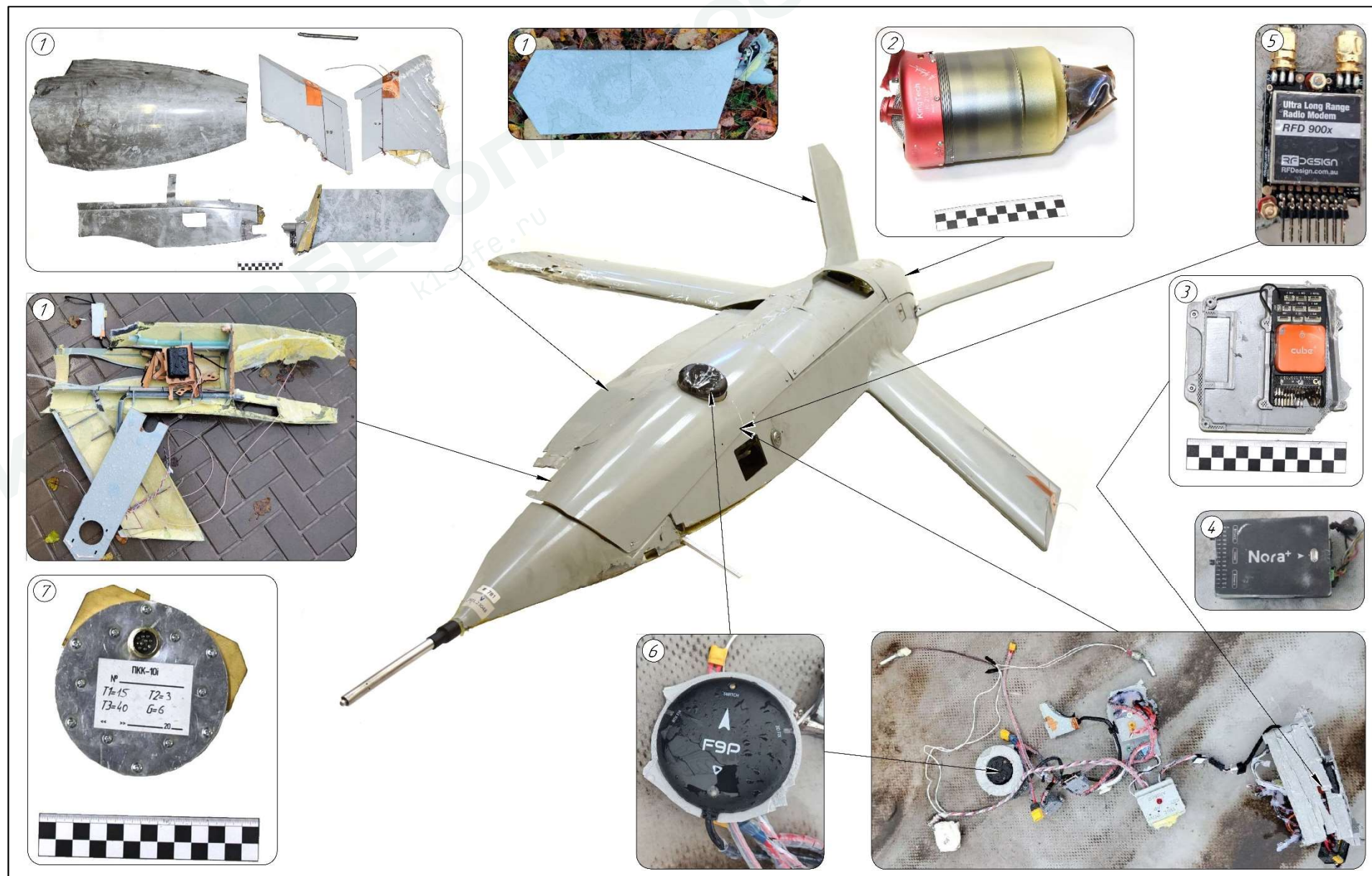
Рис. 10. Внешний вид и элементы конструкции БВС UJ-25 «Skyline»
