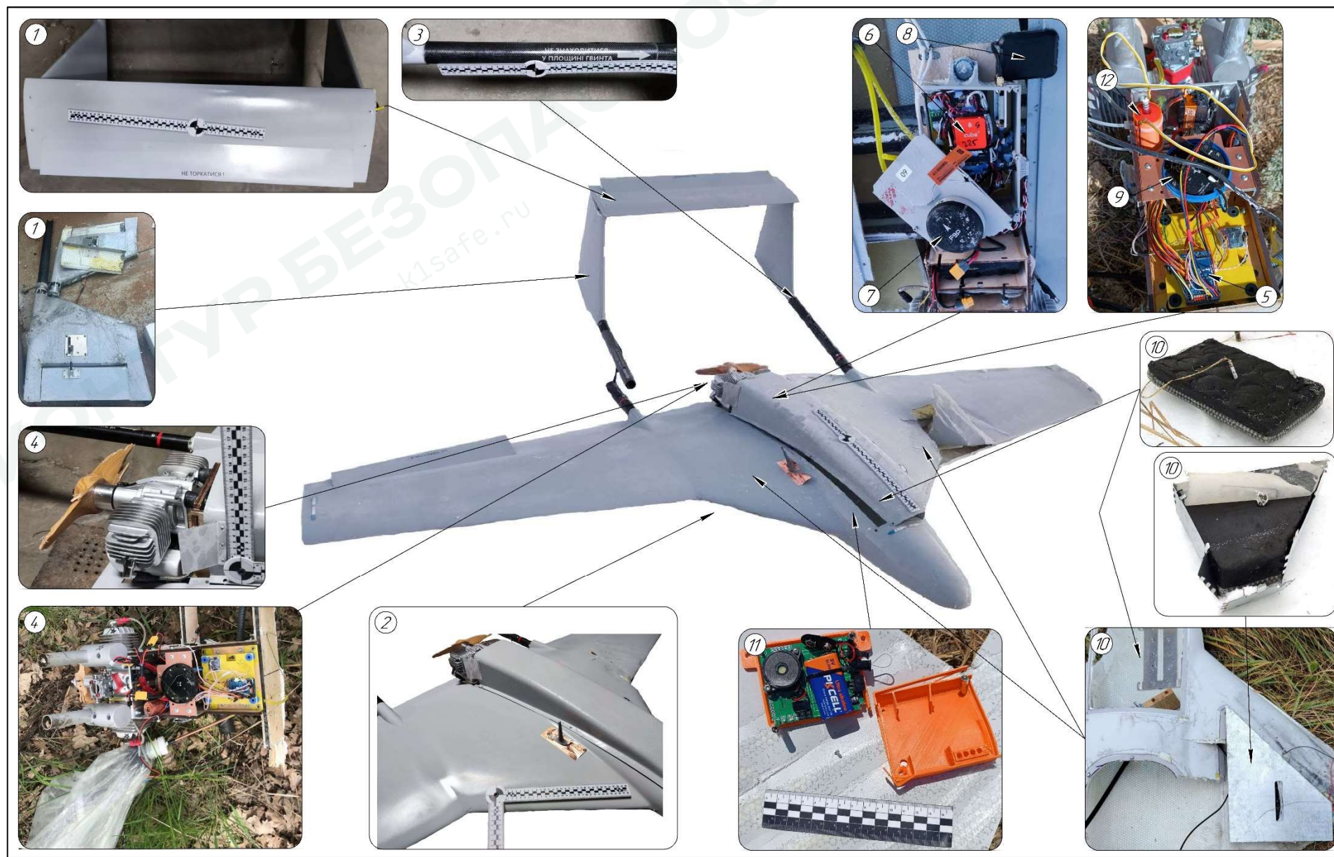
Рис. 12. Внешний вид и элементы конструкции БВС «Чаклун-В»
