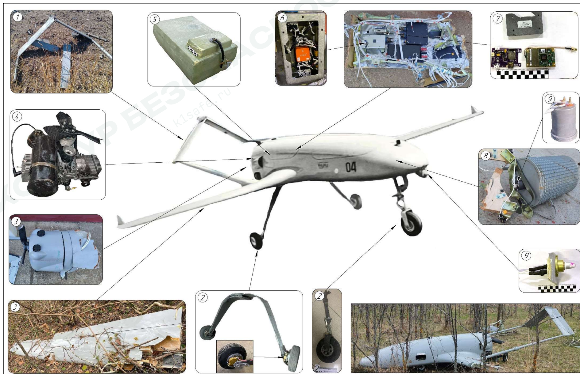
Рис. 28. Внешний вид и элементы конструкции БВС Ан-196 «Лютый»
