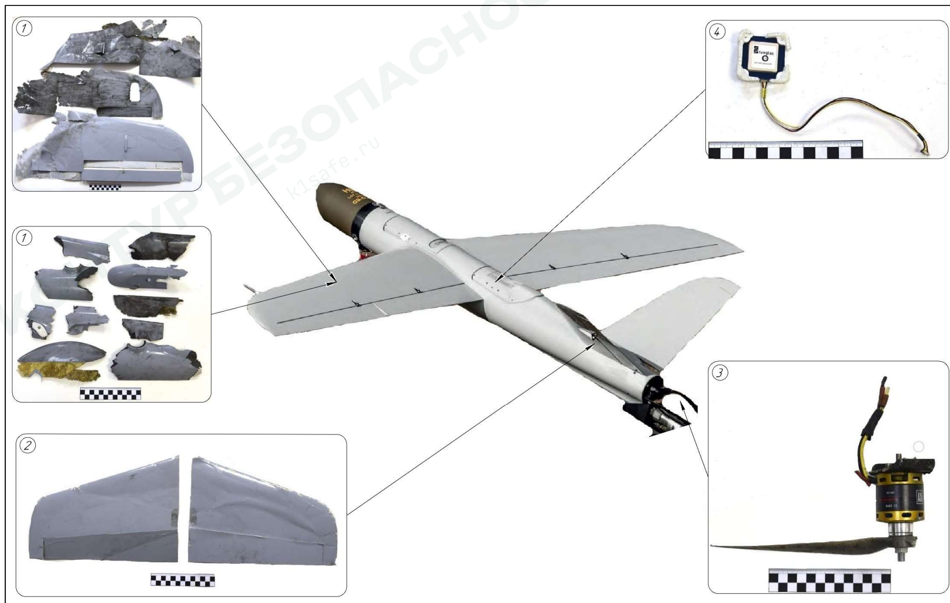
Рис. 6. Внешний вид и элементы конструкции БВС «Warmate»
